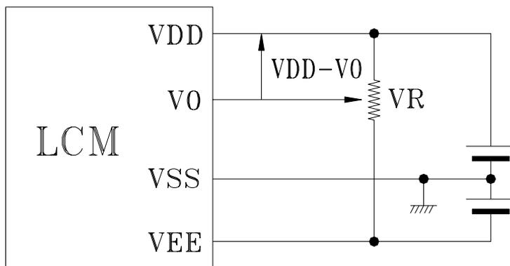
\*VDD-V0:液晶驱动电压。
