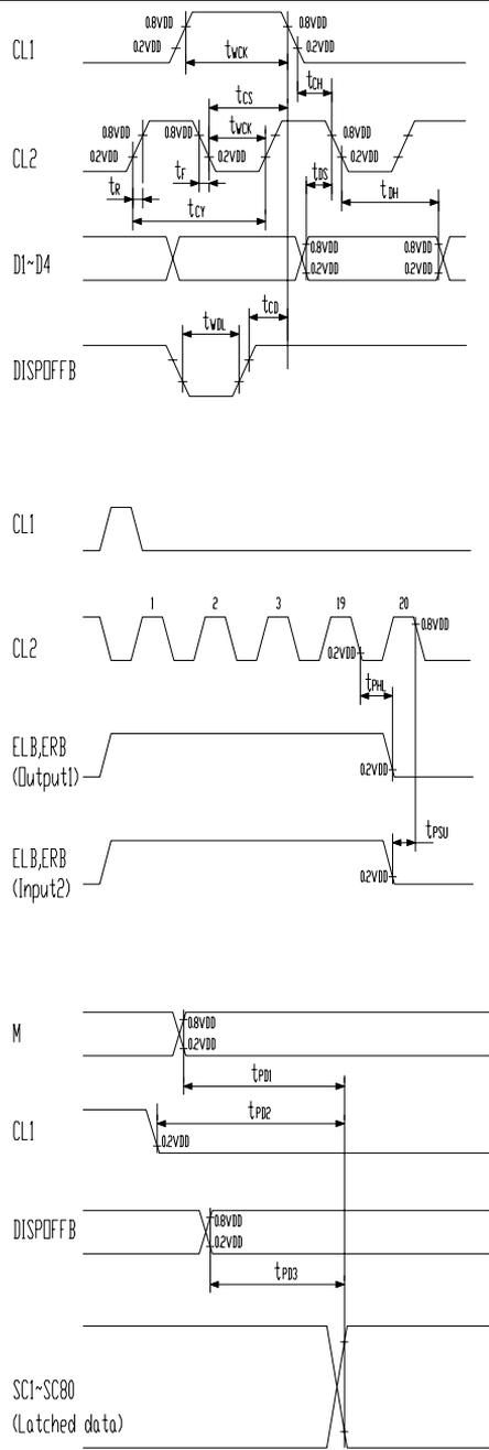
5-2-2. 行驱动时序及时序图 (  $VCC=5.0V \pm 10\%$ ,  $VSS=0V$ ,  $T_a=-30$  to  $+85^\circ C$  )
