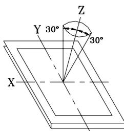
从Z轴距X, Y轴  $\phi = 30^\circ$  , 距离 $30 \pm 5\text{cm}$ 范围内检验。
