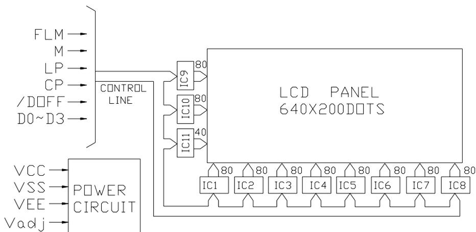
注释: 当信号线直接连到 C - MOS 电路且没有内部上拉或下拉电阻时, 有必要隔离外部干扰来保护信号线。
