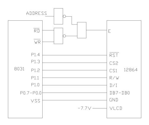
8031 数据口 P0 口直接与液晶显示模块的数据口连接,8031 的 RD,WR 作为液晶显示模块的读,写控制信号,通过与非门连接到 EDM12864-66。
